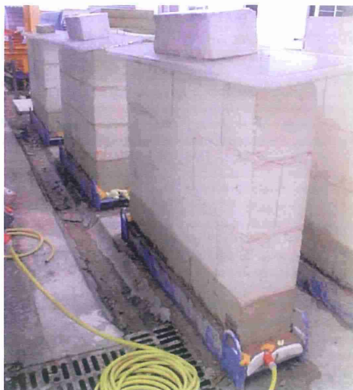
POUR L'EXPÉRIMENTATION, sept murets ont été construits en moellons de tuffeau et se sont vu appliquer différents procédés de lutte contre les remontées capillaires – les mesures étant réalisées en continu par des sondes implantées dans le matériau.
